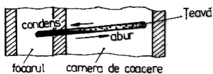
Fig. 12.4 Principiul de încălzire al cuptoarelor cu țevi Perkins
